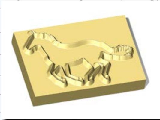
Fräsimulation eines Flachprägestempels
