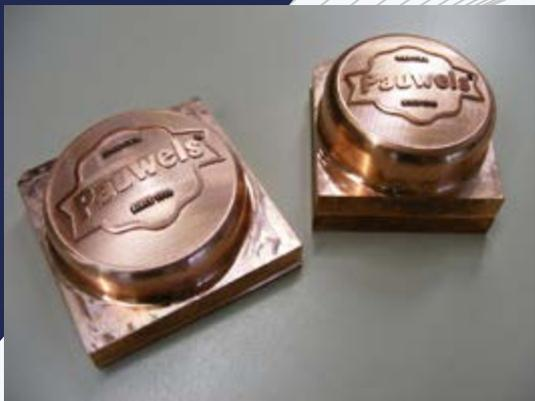
Kupferelektroden mit Kugeloberfläche erhaben graviert
