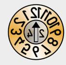
Klemmeinsatz entfernen. Hülse mittels Aushebegewinde (M4) entnehmen.
