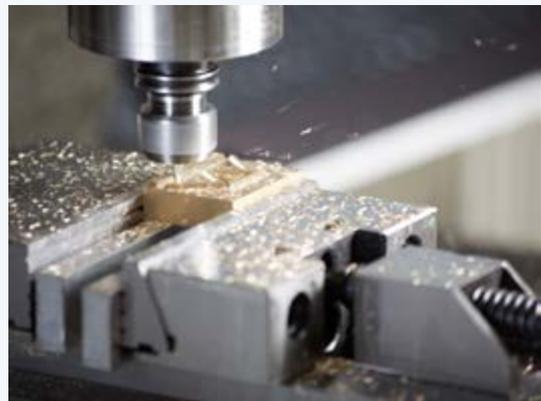
Fräsbearbeitung eines Prägestempels
