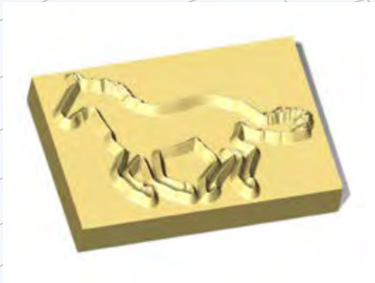
Frässimulation eines Flachprägestempels
