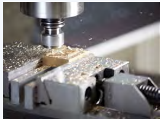
Fräsbearbeitung eines Prägestempels
