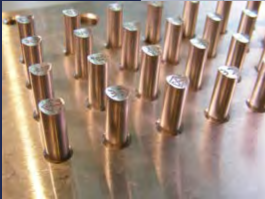
Lasergravur auf Auswerfer mit Zylinderradius
