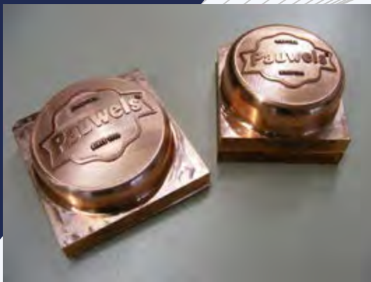
Kupferelektroden mit Kugeloberfläche erhaben graviert
